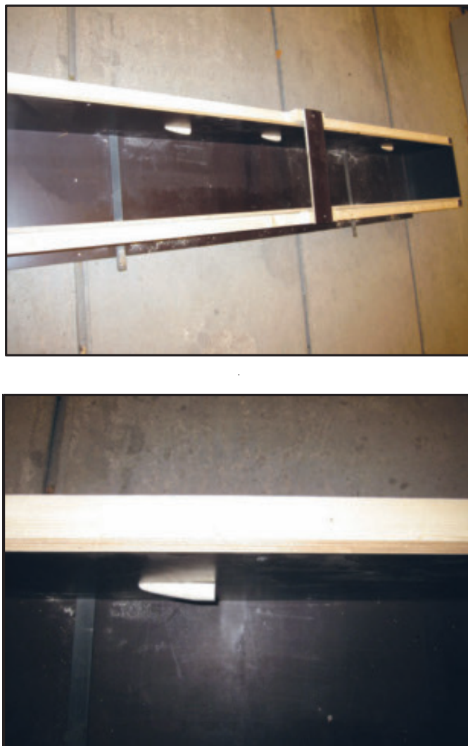
Figure 3.1: (a) Test-beam mould and (b) slot for accelerometers. (a) Gjutform för balken och (b) plats för accelerometrar.
