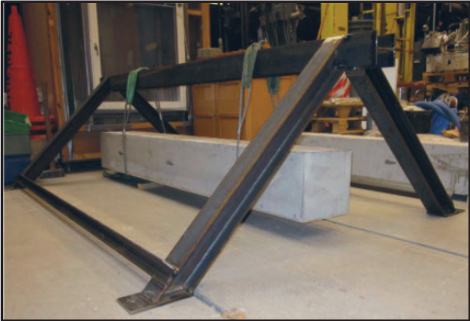
Figure 4.3: Steel frame with suspended test-beam. Stålräm med hängande balk.
