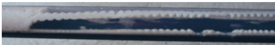
Figur 19. Ny strängladdningstyp. Thin strings of pump-emulsion (Foto Forcfit)
