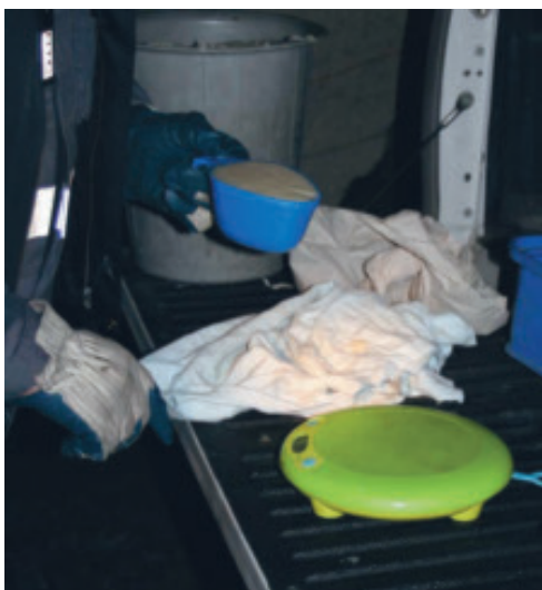
Figur 28. Kopptest. Cup-test for density (Foto LKAB)
