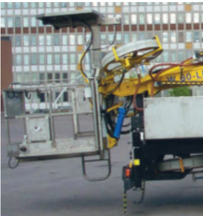
Figur 13. Slangvinda. Hose feeder (Foto LKAB)
