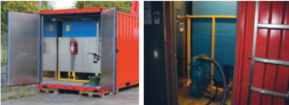
Figur 6. Lagringstank av matris i uppvärmd container. Storage tank for emulsion (Foto Forcitr och EDZ-Consulting)
