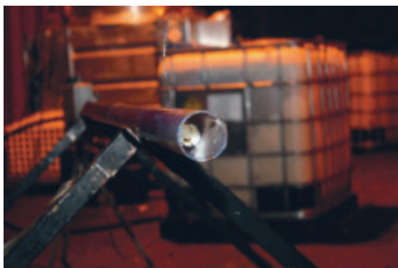
Figur 35. Laddslangen i plexiglasröret innan laddning. Charging-hose in a PVC-pipe (Foto EDZ-Consulting)
