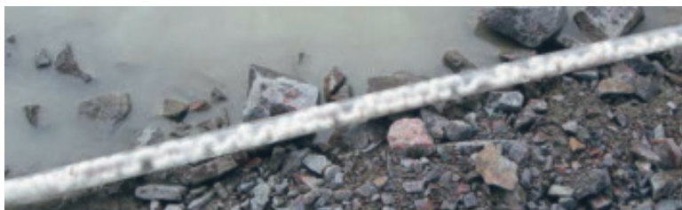
Figur 18. Pumpemulsionssträng med ondulerande laddsträng. Pump-emulsion with undulating string (Foto EDZ-Consulting)
