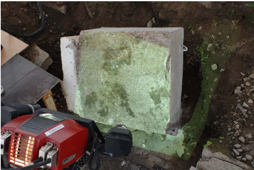
Figur 3.7 Mätning av ytråhet med optisk scanning. Measurement of surface roughness with optical scanning.
