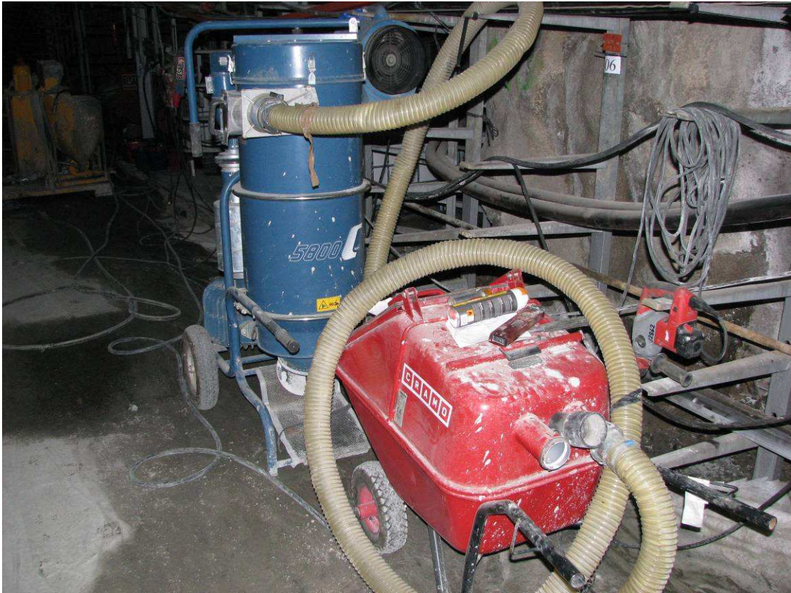
Figur 4-4 Dammsugare med stoftavskiljare som kopplas till borrhmaskinen.
