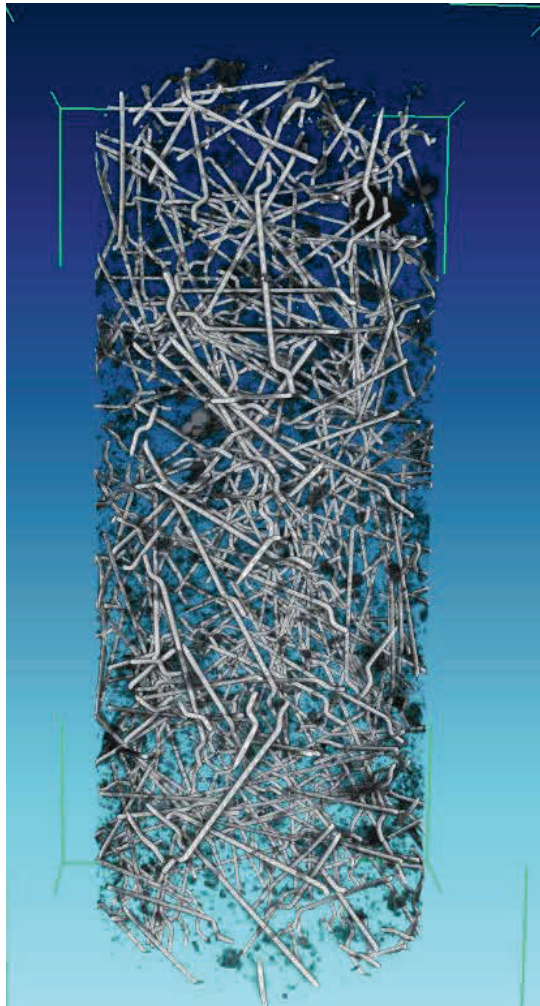
Figur 33: Tredimensionell bild visande stålfibrerna i provkroppen.
