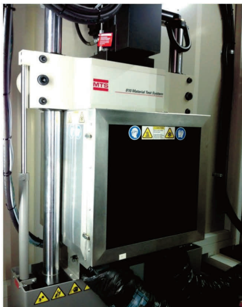
Figur 18: Mekaniskt MTS 810 i NSI X5000 systemet belastningssystem.
