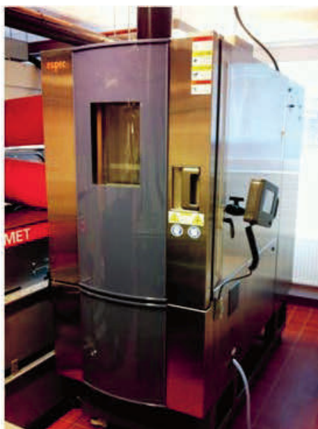
Figur 19: Klimatkammare kopplad till NSI X5000 systemet.
