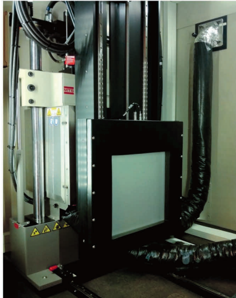
Figur 16: Digital detektor med 200 nm pixel pitch i NSI X5000 systemet.
