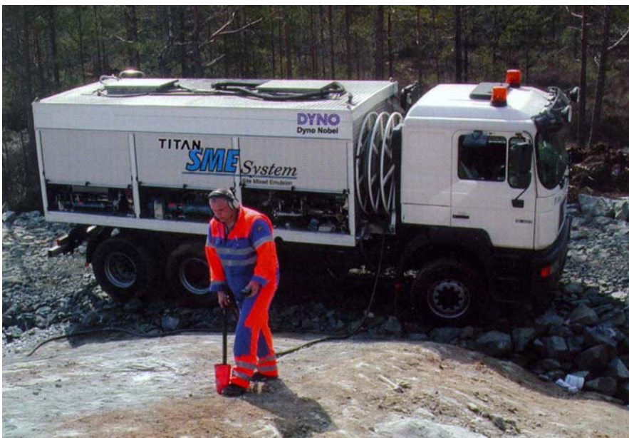
Figur 3.2. SME laddtruck från Dyno Nobel. SME betyder site mixed emulsion.
