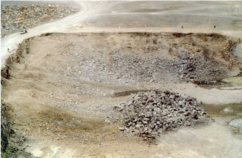
Figur 3.5c. Samma salva som i figur 3b efter sprängning. Spridningen av bergmassorna är kontrollerad, dvs. klart begränsad men viss spridning krävs för en lättlastad salva.
