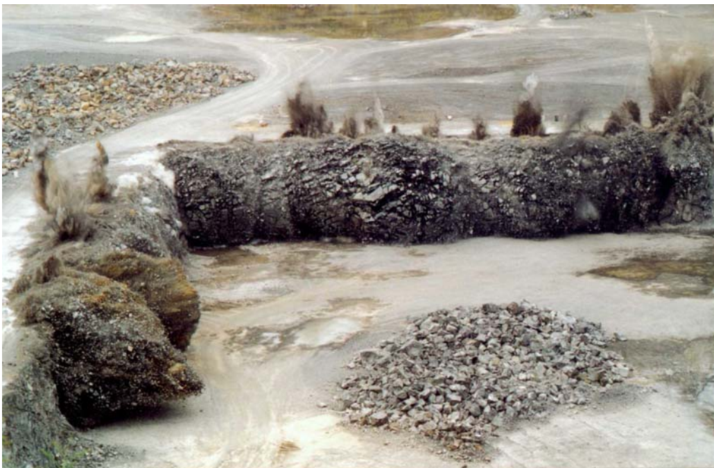
Figur 3.5b. Pallsalva med en hålrad i stenbrott under utsprängning. Ur flera hål trycker spränggaserna undan förladdningen och strömmar ut i atmosfären. En rödbrun färg brukar tolkas som att nitrösa gaser bildats. Detta sker även för syrebalanserade sprängämnen.
