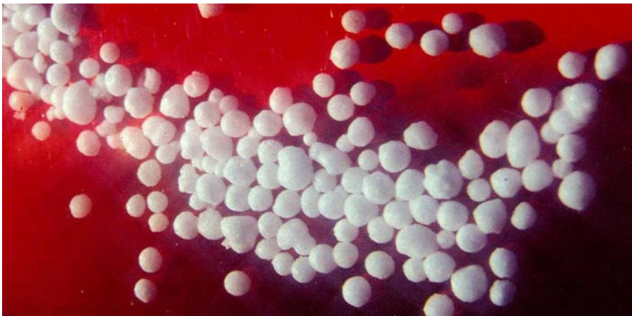
Figur 3.3. ANFO prills. Källa: Dyno Nobel.
