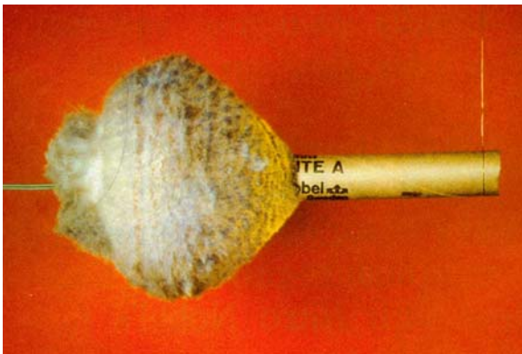
Figur 3.1. Detonerande laddning med patronerat sprängämne. Källa: Dyno Nobel.
