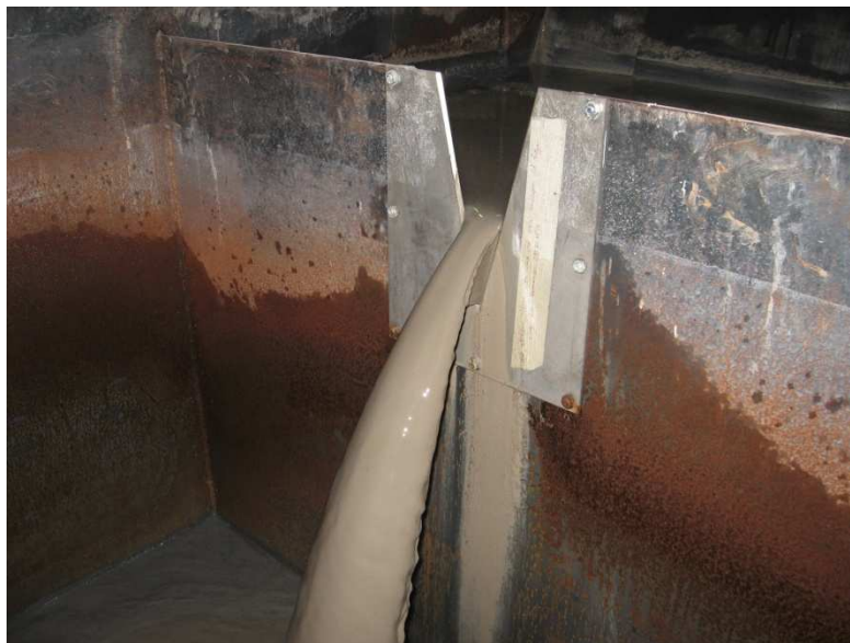
Figur 3-9. Slamblandat vatten efter tre sedimentationssteg i NL 34 Norra Länken
