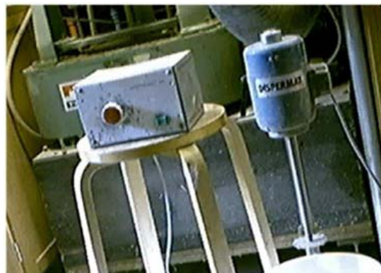
Figur 6: Labblandare som har använts att blanda bruket i denna studie. The laboratory mixer used to mix the grouts in this study
