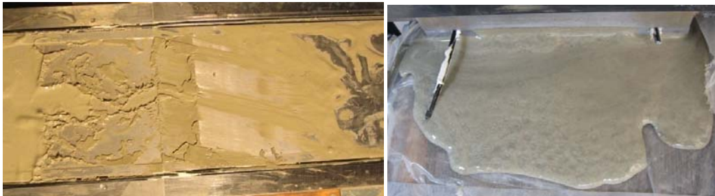
Figur 53: Fotot till vänster visar den nedre plattan vid spaltvidsminskning efter det genomförda testet. Det kan synas att filterkakan var cirka 100mm lång. En annan intressant observation som syns i fotot är en kanal i mitten av filterkakan. Fotot till höger visar bruket vid utloppet som har passerat vid slutet av test LSF14. The left picture shows the slot at the constriction after the test. It could be seen that the filter cake was approximately 100mm long and a channel existed in the middle of the filter cake. The right picture shows the passed grout at the outlet taken at the end of the LSF14 test.
