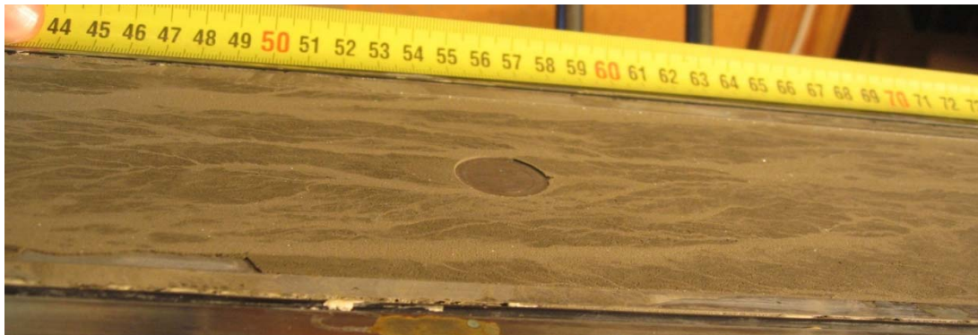
Figur 18: Ett foto från test LSS8 som visar brukets yta mellan 44 och 73 cm. Den mörkare ytan är kontaktyta och den ljusare är kanaler. A photo from test LSS8 showing the grout surface between 44 and 73 cm. The darker surface is the contact surface and the lighter surface is the channels.
