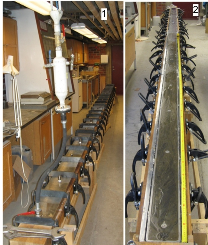
Figur 13: Foton av den 8m långa spalten under injekteringen(1) och under okulär undersökning(2). Photos of the slot during grouting (1) and during visual examination (2)
