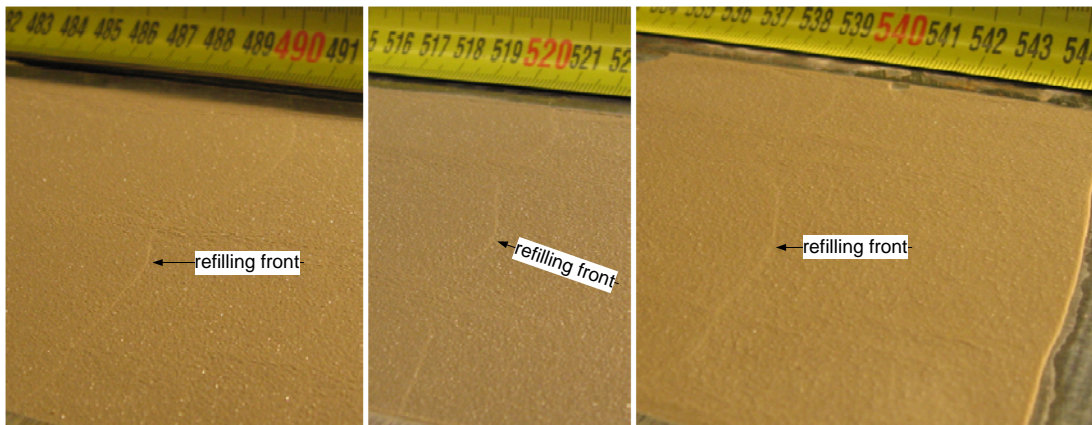
Figur 19: Tre foton från test LSS8 som visar tre påfyllningsfronter vid 490, 520 och 540 cm avstånd från inloppet. Man kan också se att brukets yta är fin och jämn samt att bruket stannade vid avståndet 5.44m från inloppet. Tree photos from test LSS8 which show the fronts of the refilling grout at 490, 520 and 540 cm distances as illustrated in Figur 10. It could also be seen that the grout surface is very even and that the grout stopped at a distance of 5.44 m.
