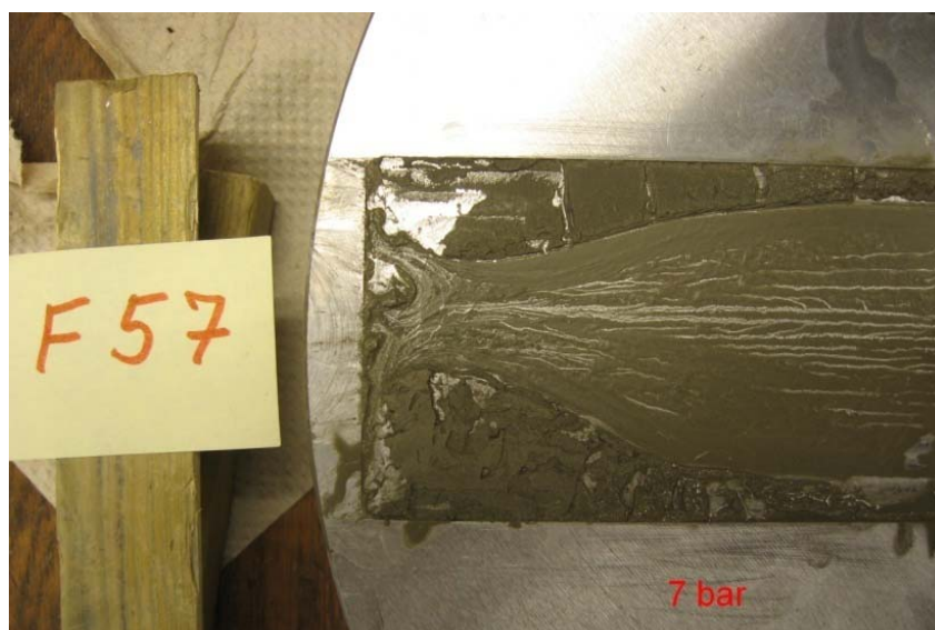
Figur 35: Fotot visar spalten efter en inträngningsmätning genomförd med 7 bars tryck (F57). Bruk INJ30 w/c=0.6 ; spalt 50\mu\text{m} . The photo shows the slot after penetrability measurement performed with 7 bar pressure. Grout INJ30, w/c = 0.6 ; aperture 50\mu\text{m} .
