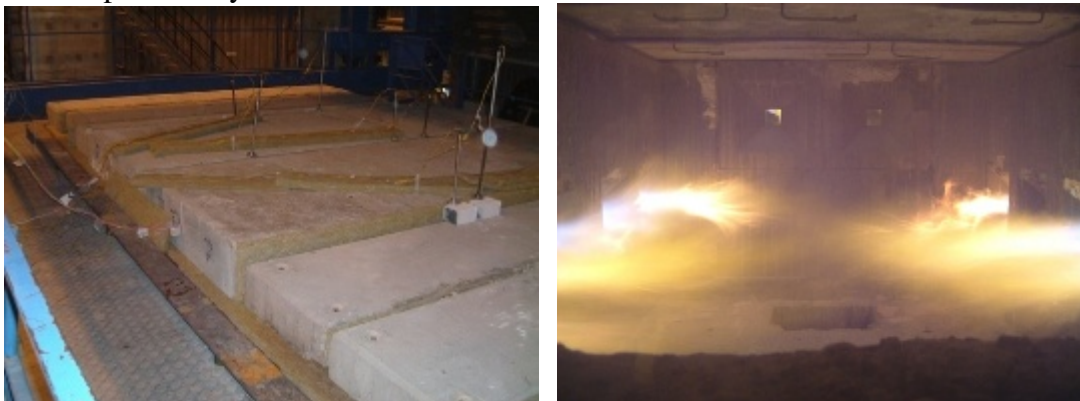
Figur 3-3 Tv. betongelement ovan ugn och T.h. upptändning av ugn
